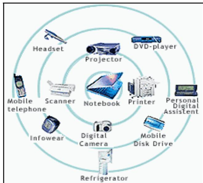
**WLAN: Wireless Local Area Network** (rete locale senza fili), è una rete locale basata su tecnologia che sfrutta le radio frequenze e permette di connettere fra loro gli HOST della rete all'interno di un'area di copertura, solitamente intorno al centinaio di metri.
